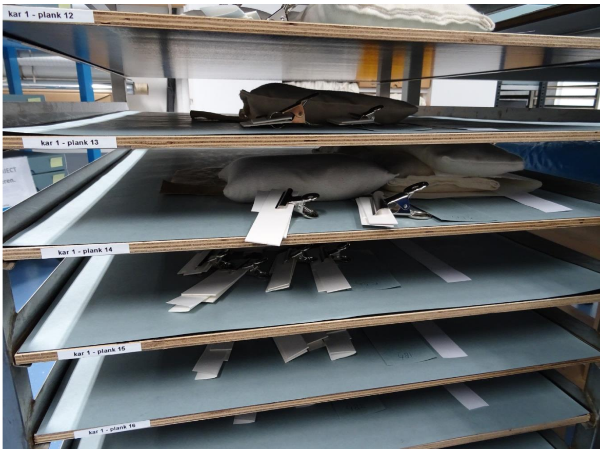
Stap 4: De planken worden in de “dienbladen”-kar geplaatst. Minimaal 48 uur droogtijd.
