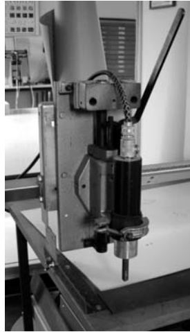
Ultrasoon lasapparaat Restauratie-atelier, Historisches Archiv Köln
