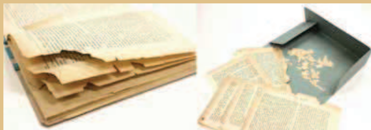
Historische testobjecten na 60 keer raadplegen: grote delen tekst raken los. Zulke objecten zouden door de meeste archief- en bibliotheekgebruikers ongeschikt geacht worden voor gebruik.
