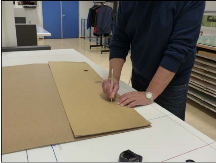
Afb. 69 Aftekenen van ventilatiegaten
